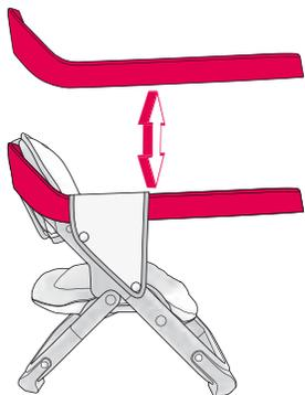
Чтобы снять поднос, откиньте подушку спинки назад и отсоедините кнопки боковых накладок чехла сиденья. Затем откройте фиксатор (05) на задней стороне сиденья и снимите поднос с сиденья в направлении вверх.
